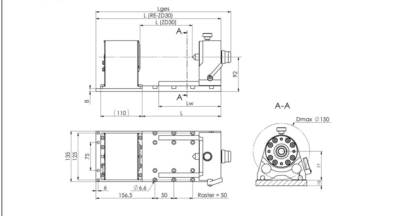
Reitstockeinheit RE-ZD30 mit Dreibackenspannfutter  $\varnothing 65$
