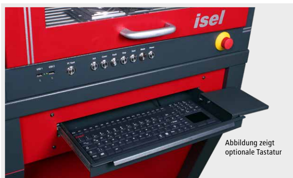
ausziehbares Tastaturfach mit ausklappbarer Mausablage
