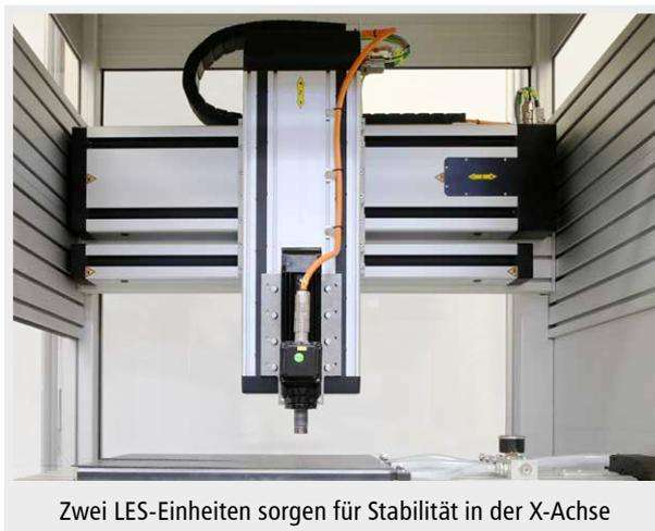
Zwei LES-Einheiten sorgen für Stabilität in der X-Achse
