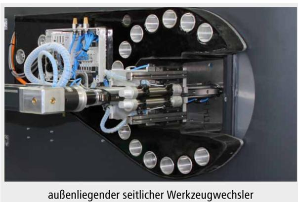
außenliegender seitlicher Werkzeugwechsler
