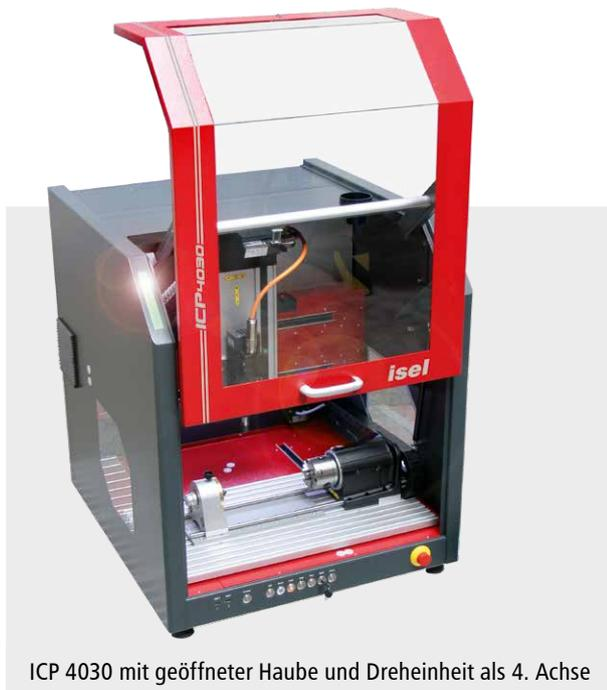
ICP 4030 mit geöffneter Haube und Dreheinheit als 4. Achse
