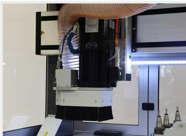
Option: Absaugvorrichtung mit Absaugkopf
