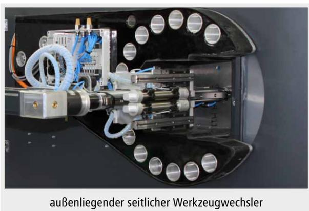
außenliegender seitlicher Werkzeugwechsler
