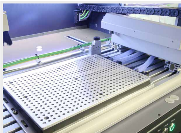
Option: Vakuumspanntisch und Linearwechsler
