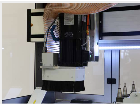
Option: Absaugvorrichtung mit Absaugkopf
