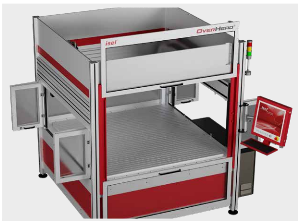
Option: seitliche Bestückung zur Integration in Fertigungsstraßen
